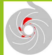
Berechnete Dampfstrukturen an einem Schiffspropeller und in einer Kreiselpumpe
