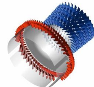
Industriedampfturbine bei Teilbeaufschlagung
