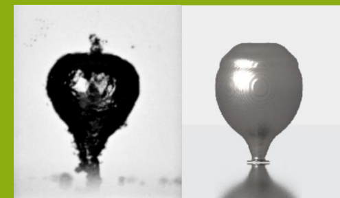
Einzelblasenkollaps in Wandnähe: Experiment (links) und Simulation (rechts).
