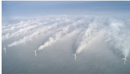
*Wirbelschleppen im Nachlauf eines Windparks. Quelle: Vattenfall*
