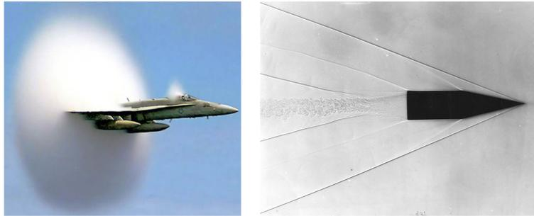
a) Schräger Verdichtungsstoß an einem Überschall-Düsenjet. Die Expansion vor dem Stoß führt zu einer Temperaturabnahme und zur Kondensation.
