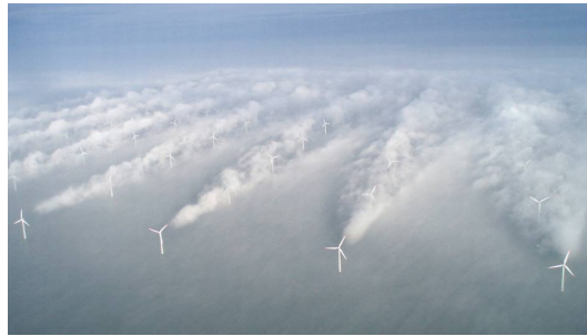
Wirbelschleppen im Nachlauf eines Windparks. Quelle: Vattenfall
