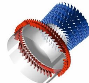
Industriedampfturbine bei Teilbeaufschlagung
