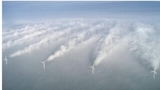
*Wirbelschleppen im Nachlauf eines Windparks. Quelle: Vattenfall*
